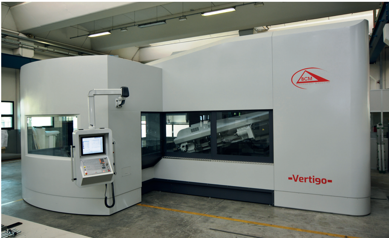
III Vertigo è un centro di foratura/fresatura a marchio BCM, per la lavorazione di stampi di grandi dimensioni.
